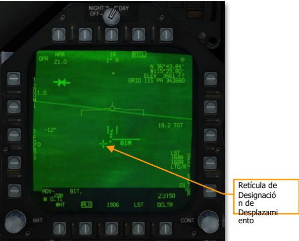
Figura 111. Retícula de Designación de Desplazamiento
