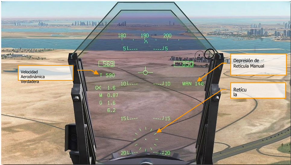
Figura 169. HUD de Bombardeo MAN (Manual)
