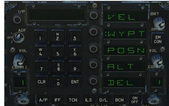
Figura 223. Creación de STP para SLAM-ER
