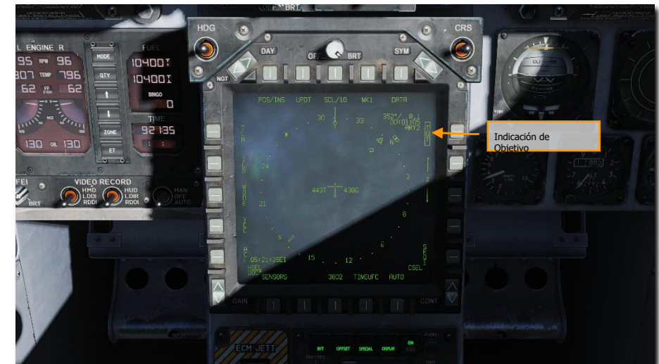
Figura 166. Bombardeo AUTOMÁTICO, Punto de Ruta Designado como Objetivo (TGT)
