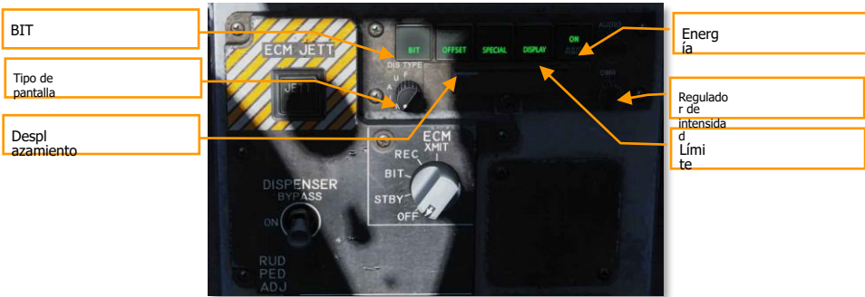
Figura 234. Panel de Indicadores de Control
