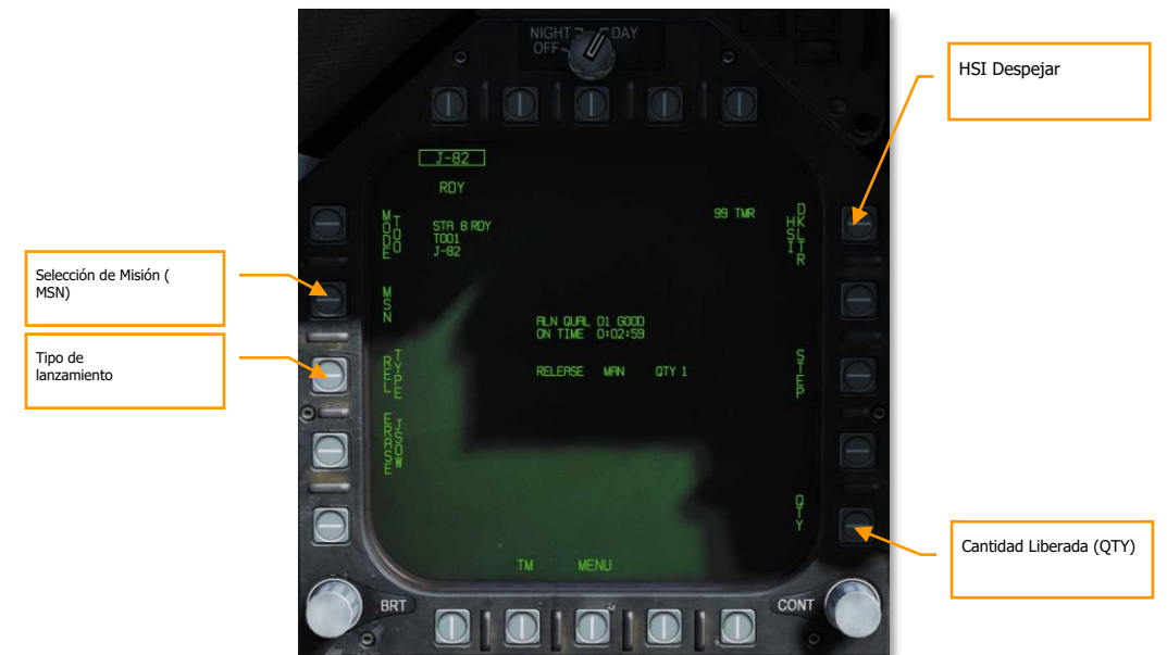
Figura 182. Formato de SMS para Arma GPS
