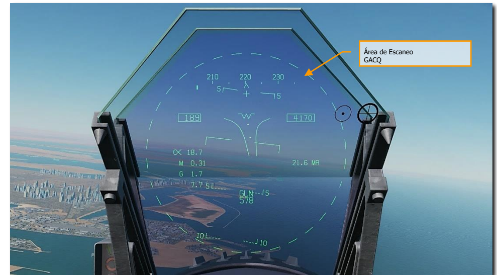
Figura 137. Área de Adquisición Automática de Cañones A/A
