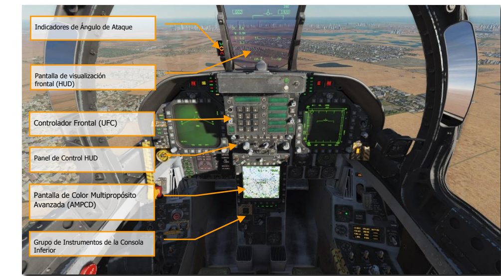
Figura 5. Panel de Instrumentos Central
