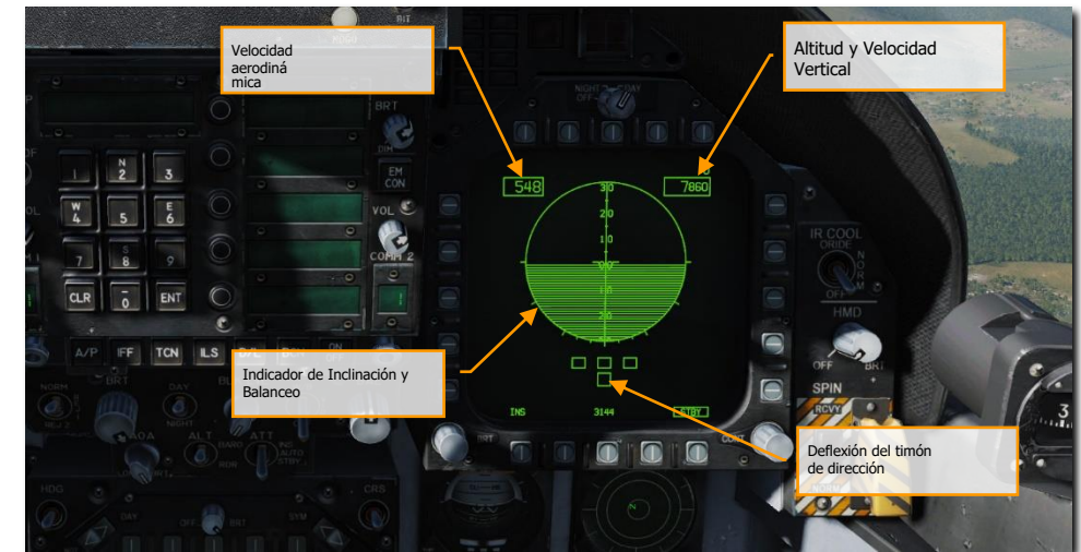
Figura 29. Indicador Electrónico de Actitud (EADI)
