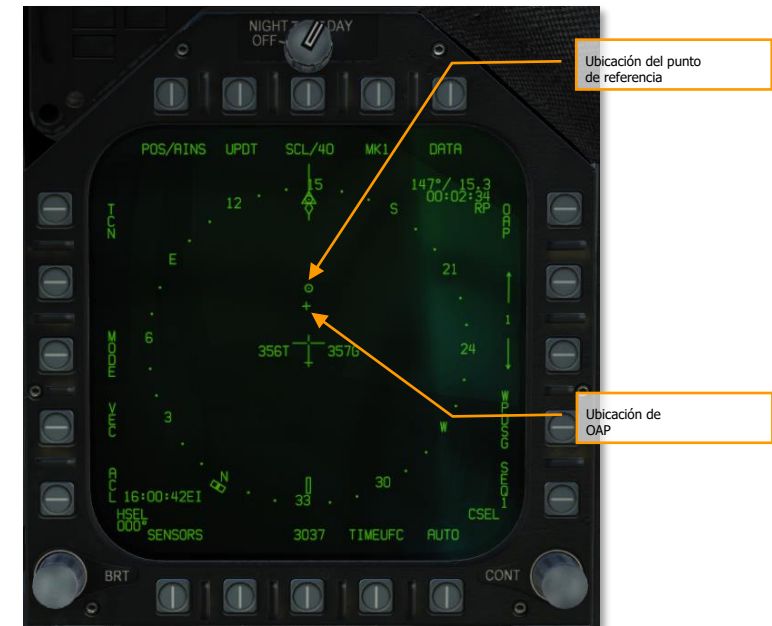
Figura 57. Punto de mira desplazado en el HSI
