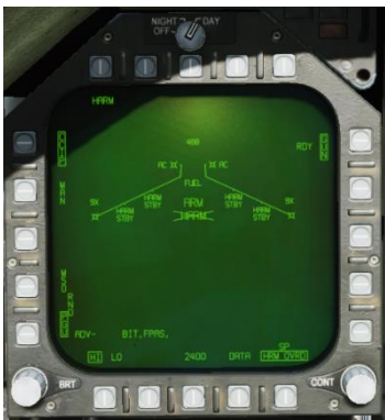
Figura 207. Etiqueta "HARM" tachada.
