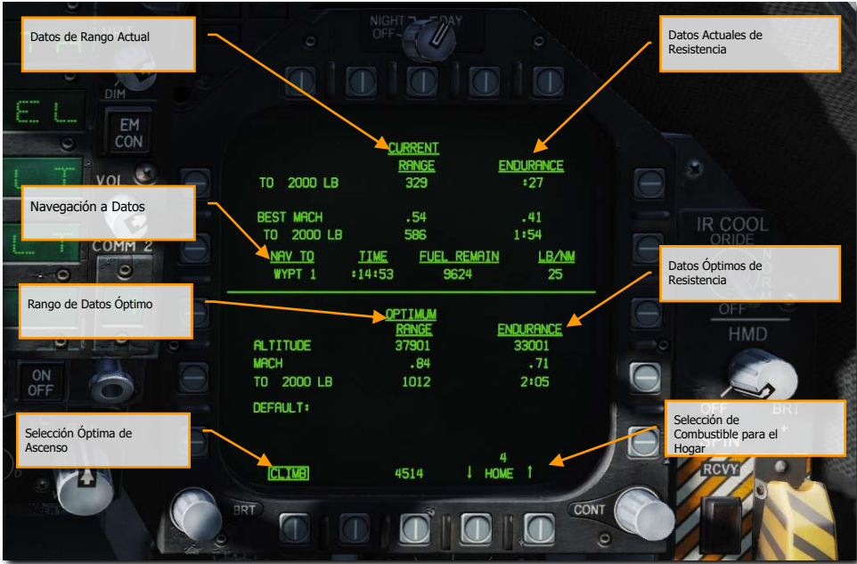
Figura 31. Página del Sistema de Asesoramiento de Rendimiento de Vuelo (FPAS)
