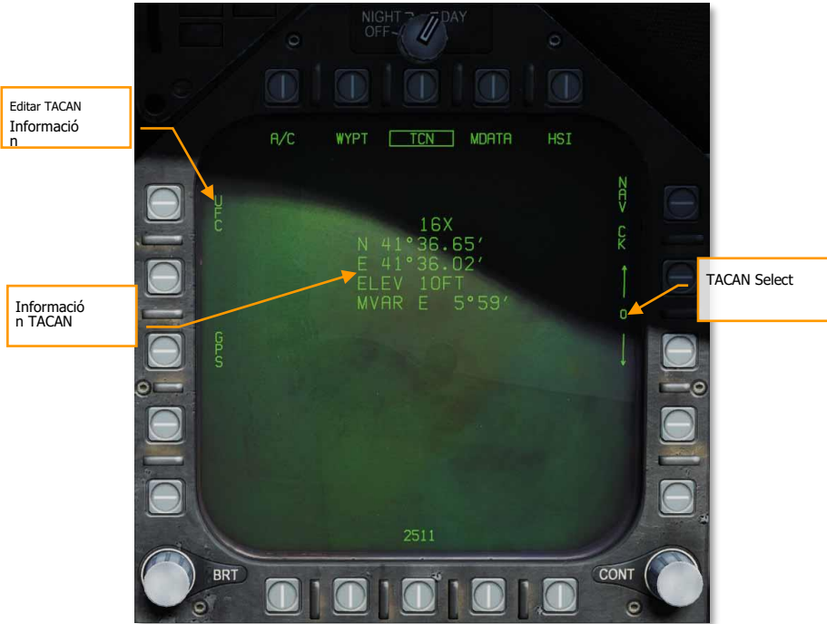
Figura 66. Subnivel de DATOS HSI TACAN
