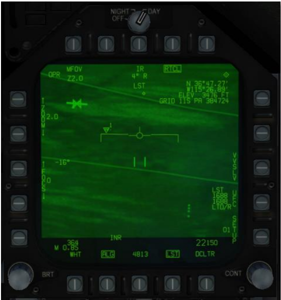
Figura 113. Pantalla LST después de la detección láser
