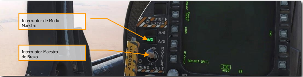
Figura 159. Selector de Modo Maestro A/G
