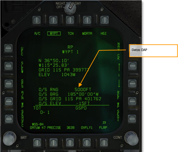
Figura 56. Datos del Punto de Mira Desplazado
