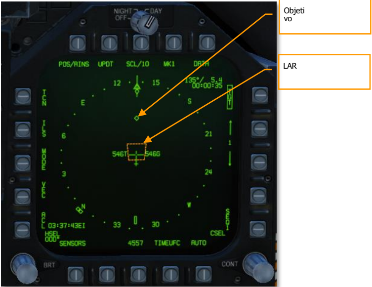
Figura 178. Formato HSI, Ataque Paveway III
