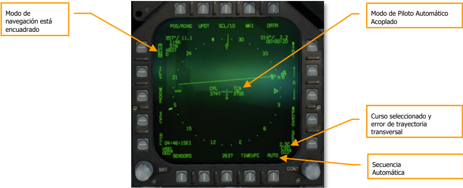
Figura 71. Controles de Piloto Automático Acoplados en el HSI
