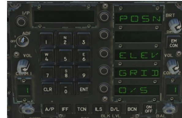
Figura 50. Opciones UFC de Puntos de Referencia (WYPT)
