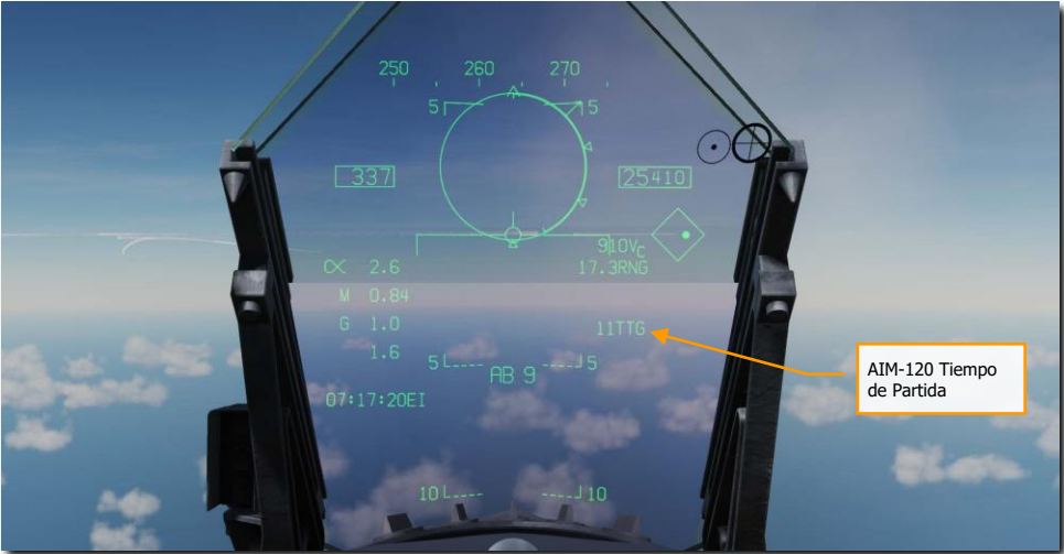
Figura 157. Seguimiento por radar del AIM-120, HUD poslanzamiento
