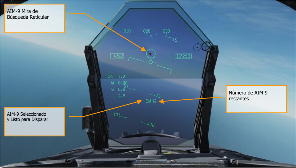
Figura 143. AIM-9 HUD, línea de mira del buscador
