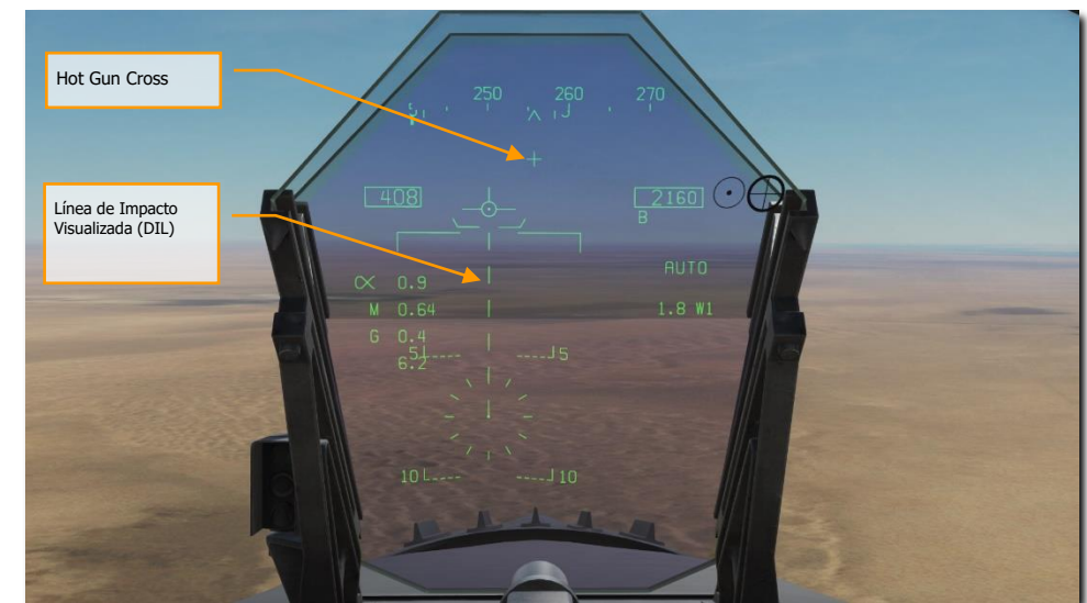
Figura 164. HUD de Bombardeo AUTO, Sin Designación &lt;7.5° Ángulo de Picado
