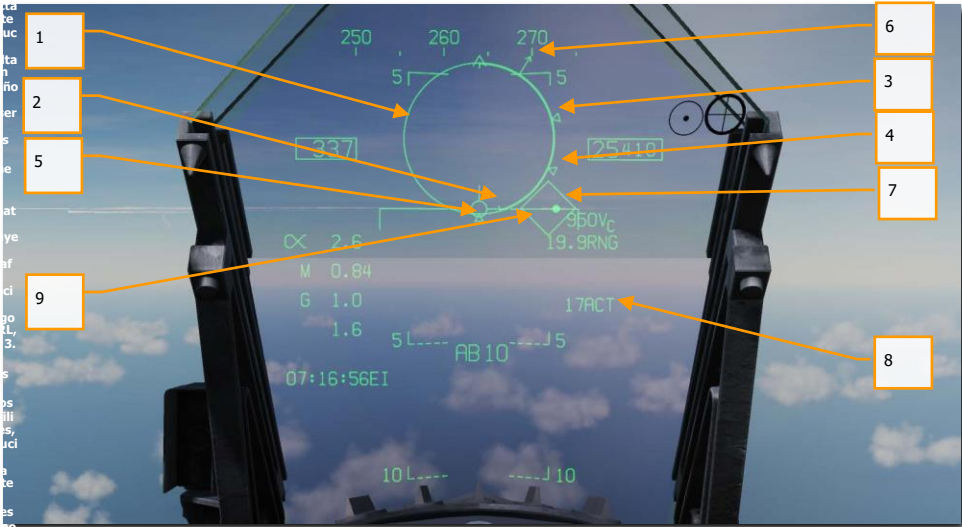
Figura 155. HUD del AIM-120 con Bloqueo de Radar, Previo al Lanzamiento
