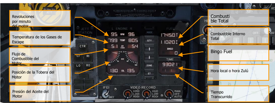
Figura 4. Indicador Integrado de Combustible/Motor (IFEI)
