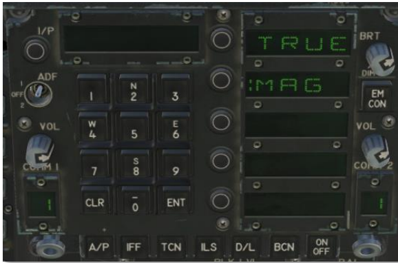
Figura 53. Menú de rumbo de punto de mira compensado
