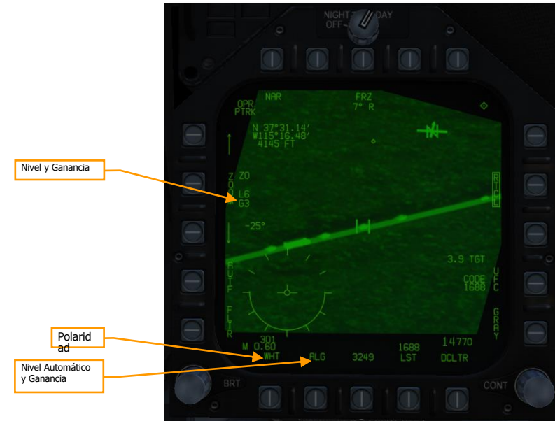
Figura 118. Formato FLIR en modo FLIR
