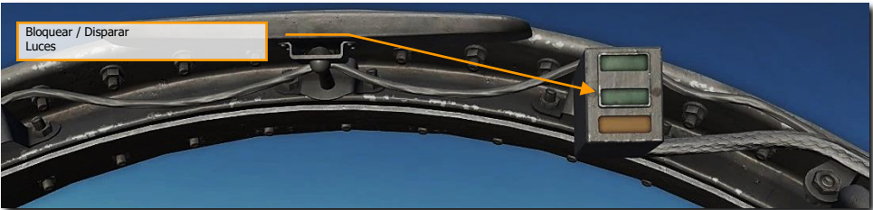
Figura 10. Luces de Bloqueo y Disparo
