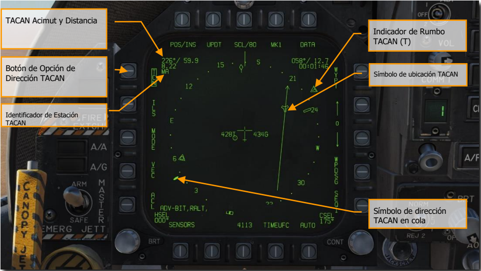
Figura 62. Direccionamiento TACAN en el HSI
