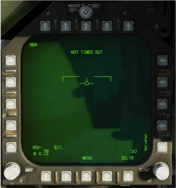
Figura 104. Formato ATFLIR en modo NO PREPARADO.
