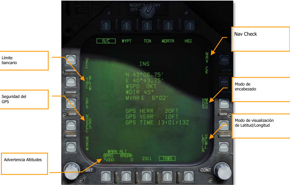
Figura 64. Subnivel DATOS del HSI de la aeronave
