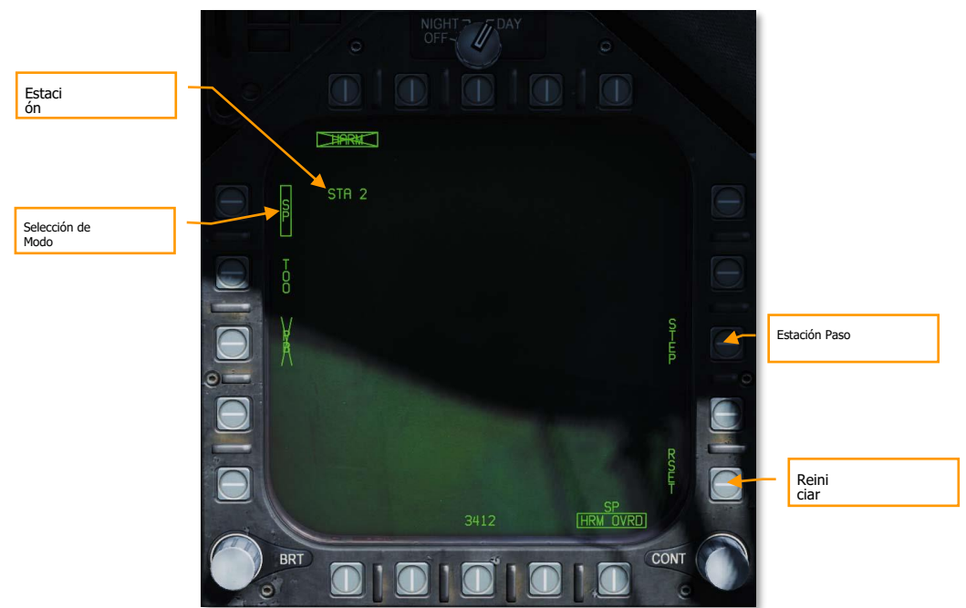
Figura 203. Formato HARM SP SMS
