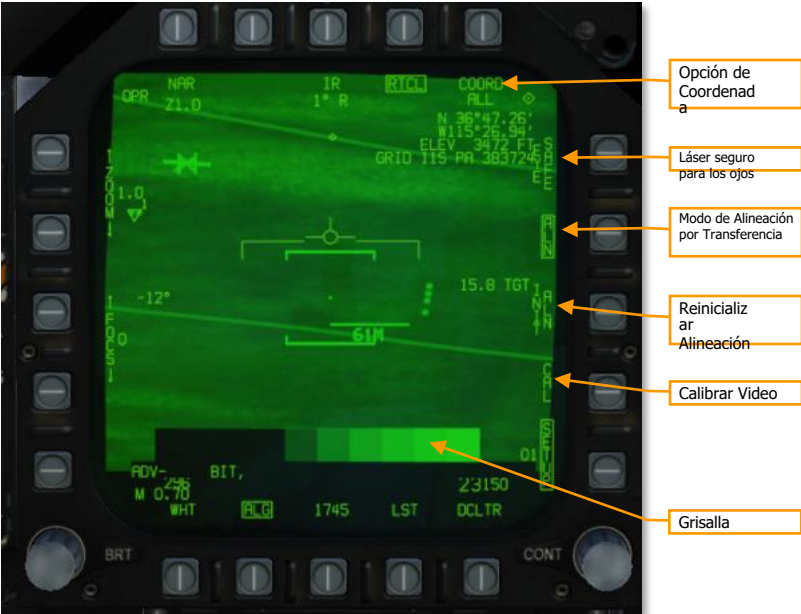
Figura 110. Menú de configuración ATFLIR.
