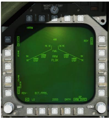
Figura 208. Etiqueta "PLBK" mostrada cuando el Pullback está inhibido.
