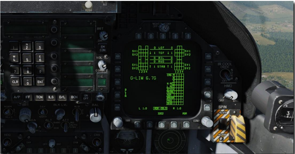
Figura 27. Página del Sistema de Control de Vuelo (FCS)
