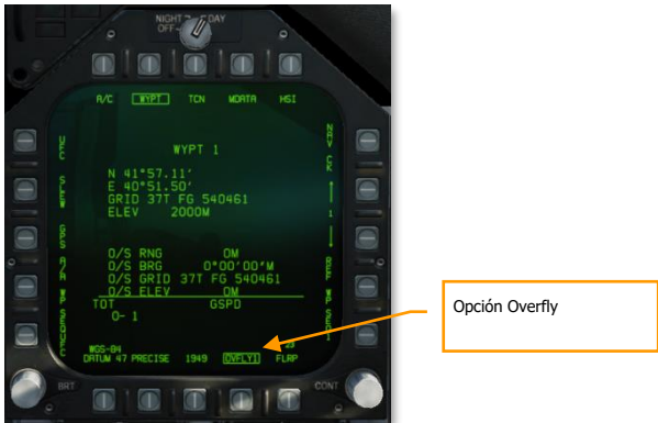
Figura 73. Controles de piloto automático acoplados en la página WYPT del HSI
