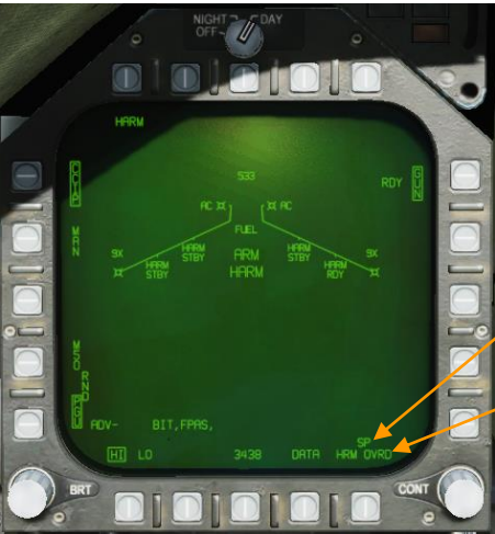
Figura 205. HRM OVRD inactivo, modo Pullback activo.
