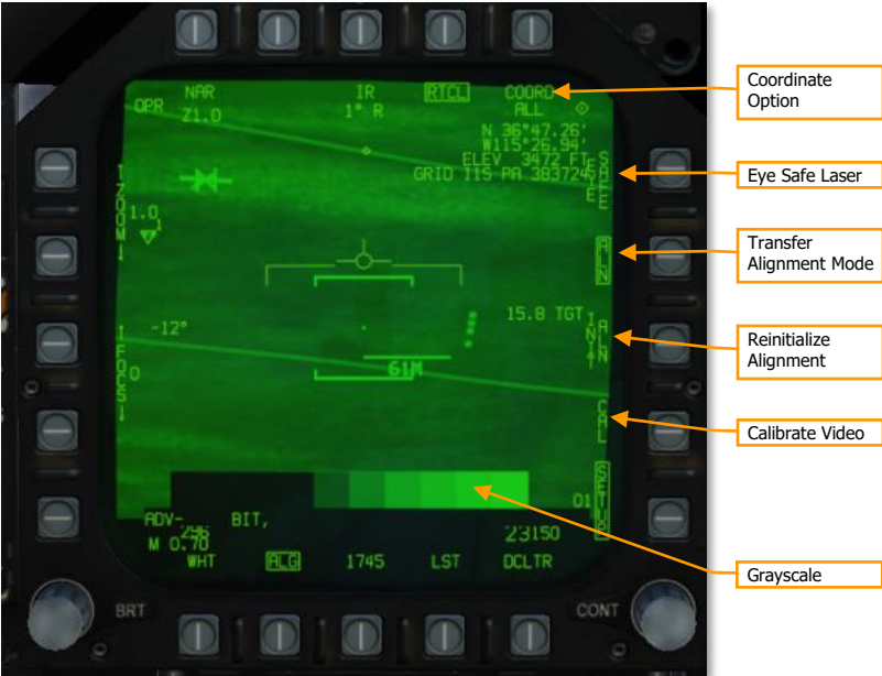
Figure 110. ATFLIR SETUP menu.
