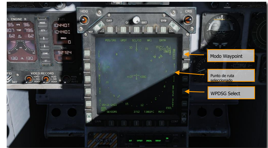
Figura 165. Bombardeo AUTOMÁTICO, Sin Designación
