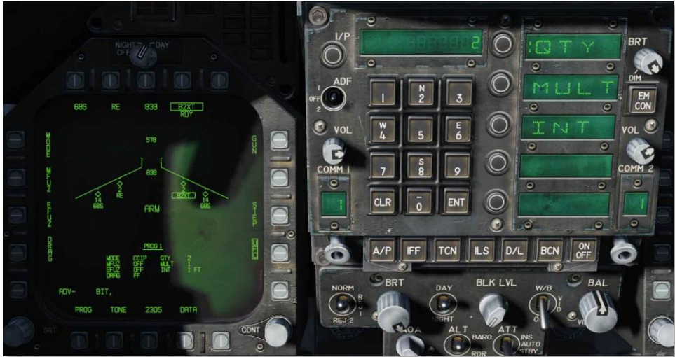
Figura 161. Configuración de Bombas UFC
