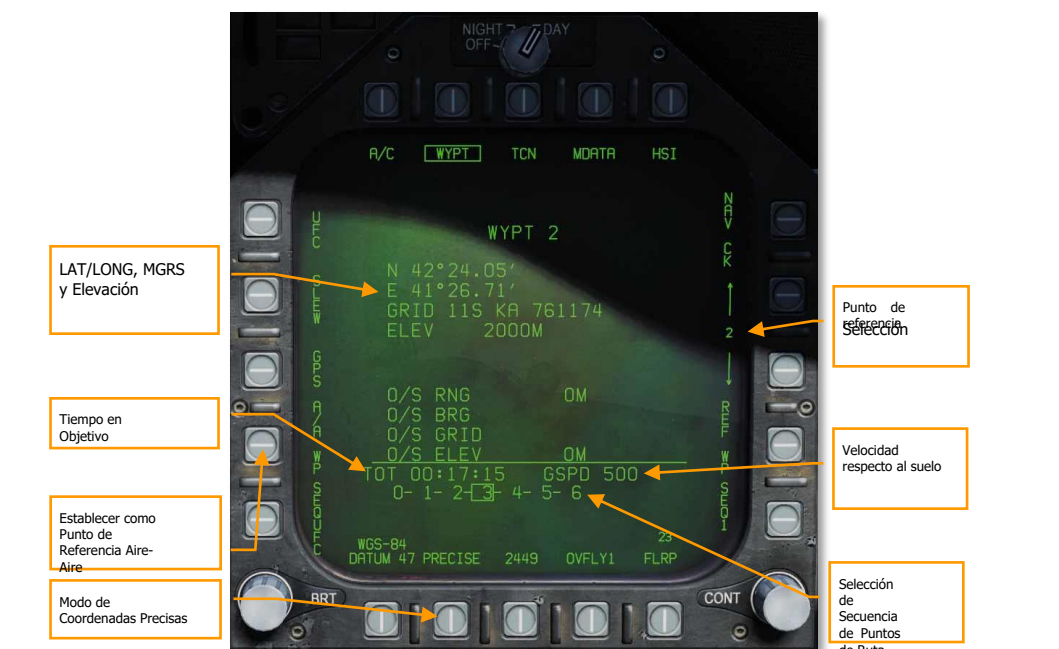
Figura 65. Subnivel de DATOS HSI de punto de referencia
