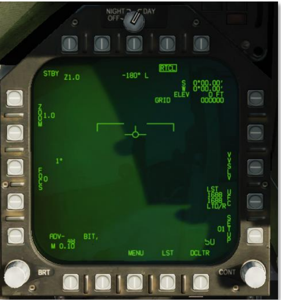
Figura 105. Formato ATFLIR en modo STBY.
