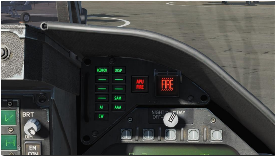
Figura 235. Panel de visualización de advertencias/avisos/amenazas del panel derecho de instrumentos
