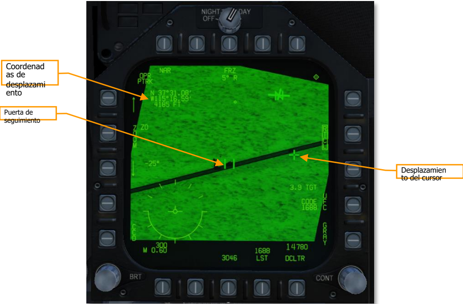
Figura 120. Modo PTRK con cursor desplazado
