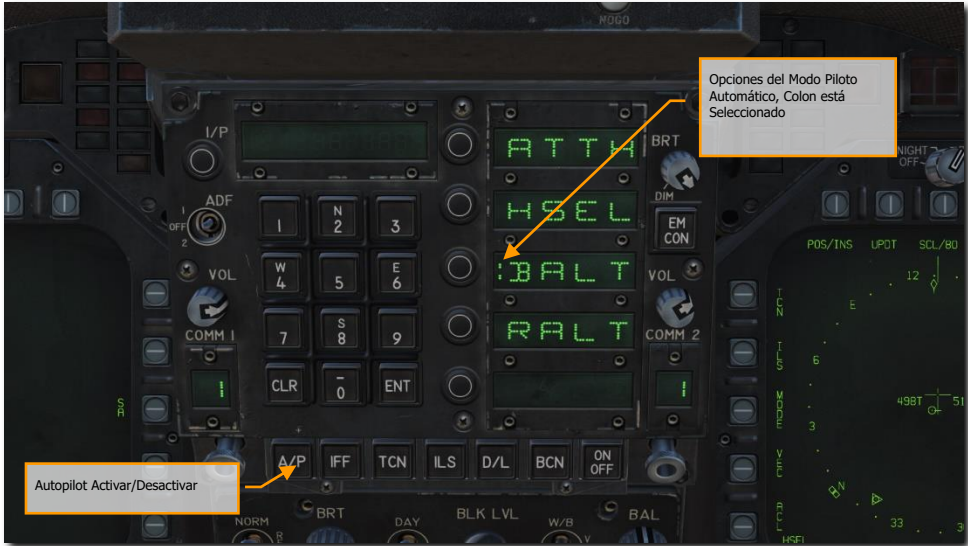
Figura 70. Modos de Piloto Automático UFC
