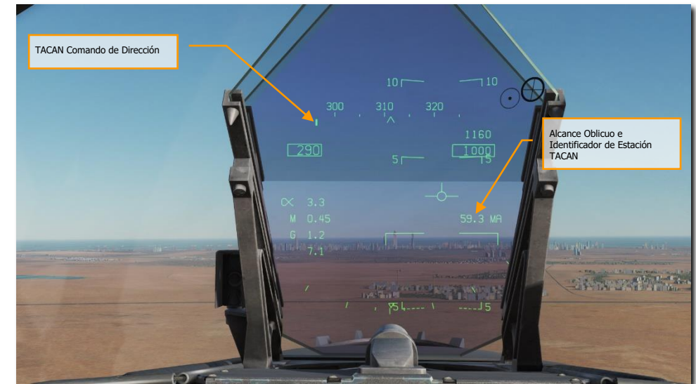
Figura 63. Direccionamiento TACAN en el HUD
