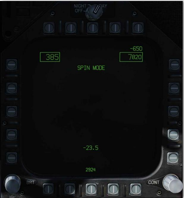
Figura 13. Pantalla de Recuperación de Giro
