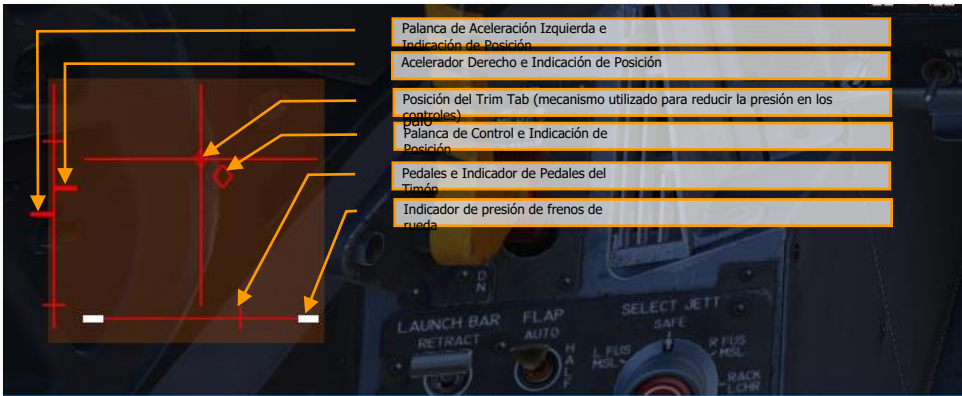
Figura 1: Indicador de controles en pantalla
