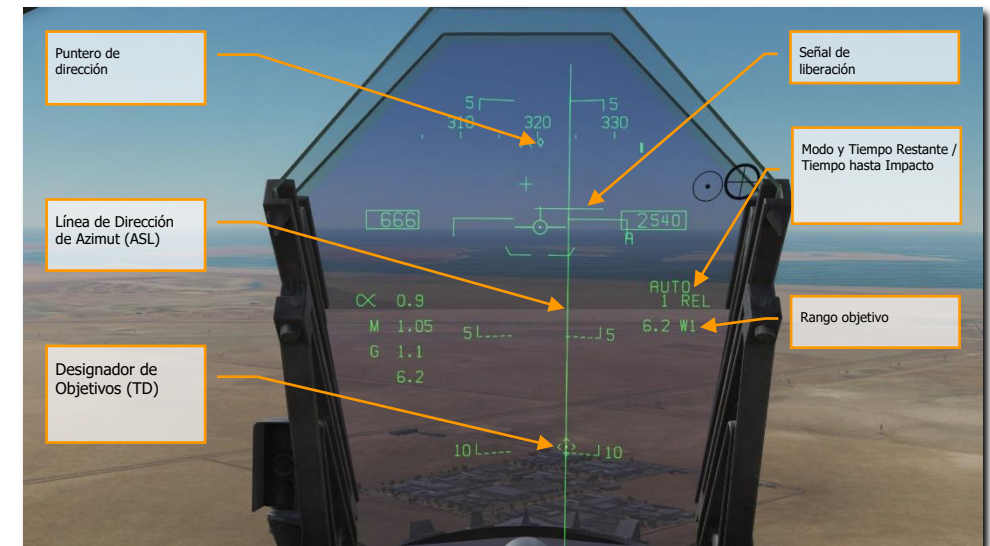
Figura 168. HUD de Bombardeo AUTO, Designado
