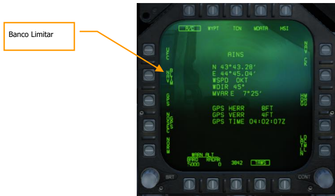
Figura 72. Controles de Piloto Automático Acoplados en la Página A/C del HSI
