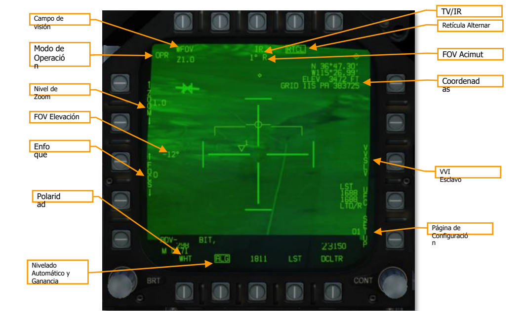
Figura 106. Formato ATFLIR en modo OPR (controles).
