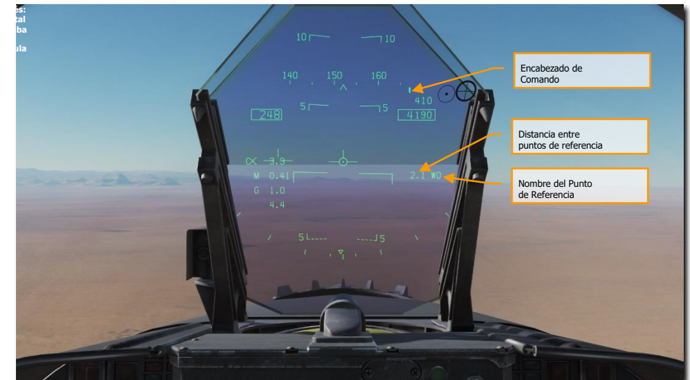
Figura 43. Navegación por puntos de referencia en el HUD
