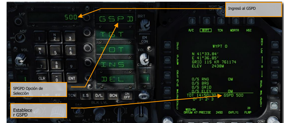
Figura 47. Ingreso de Datos de Velocidad Terrestre
