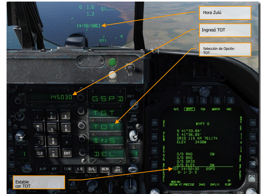
Figura 46. Entrada de Datos de Tiempo en Objetivo
